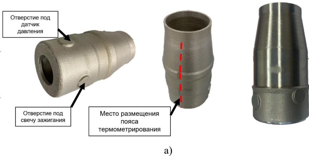
Рисунок 2.13 – Схема жаровой трубы
