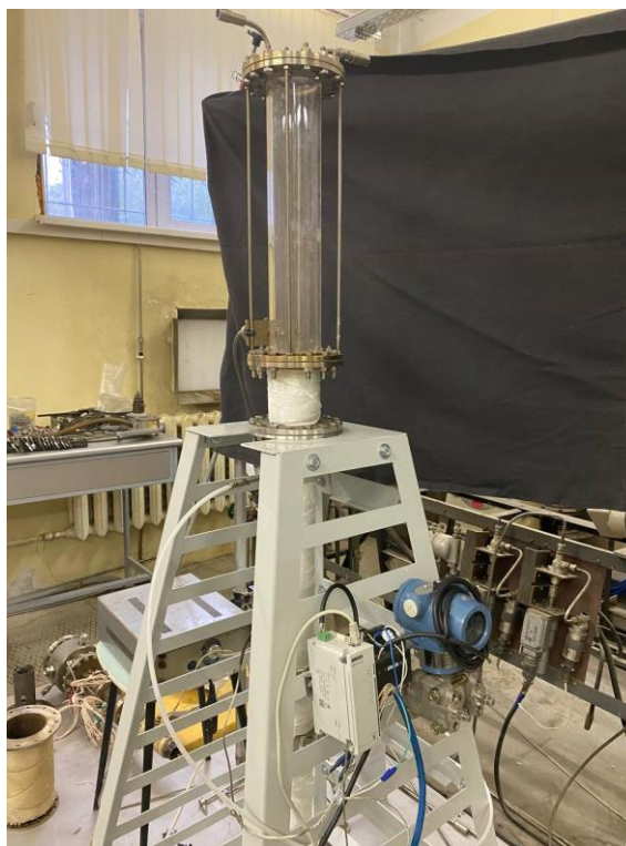
Рисунок 2.21 – Установка по определению границы устойчивой работы
